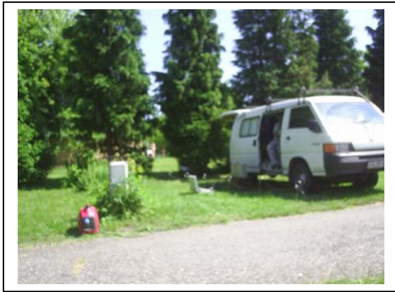
Fotók: A medence melletti szelvény mérése A földbe szúrt elektródák és a mérőkocsi (A forrás a nádfonású fal mögött található)
